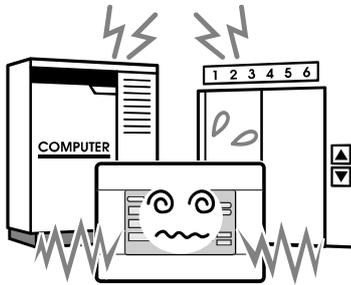
Если устройство установлено рядом с компьютером, автоматическими дверями, лифтом или оборудованием, генерирующим шум, устройство может функционировать неправильно.
