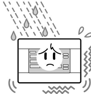
Если устройство установлено там, где оно подвергается воздействию влаги, брызг воды или сильной вибрации, это приведет к неправильной работе.
