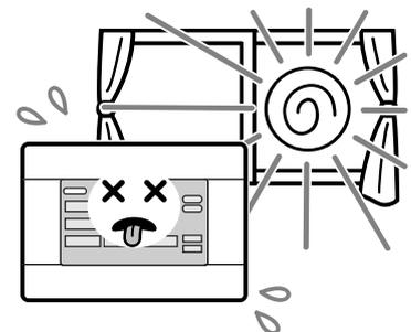
Расположение устройства под прямыми солнечными лучами или рядом с нагревательными приборами приведет к неправильному функционированию устройства.
