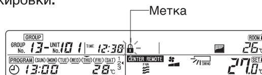
4. Нажмите кнопку функции, управление которой с пульта дистанционного управления вы хотите запретить (TEMP (ТЕМПЕРАТУРА) (▲ или ▼), MODE (РЕЖИМ), FAN SPEED (СКОРОСТЬ ВЕНТИЛЯТОРА) или RUN/STOP (ПУСК/ОСТАНОВ)).
