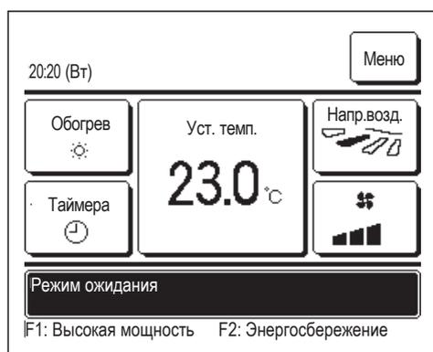
Чтобы исключить подачу холодного воздуха из ИО в начале операции обогрева, устройство останавливает вентилятор, и на дисплее сообщений появляется сообщение «Режим ожидания». Когда устройство будет готово к подаче горячего воздуха, сообщение «Режим ожидания» исчезнет, и устройство приступит к обогреву.
