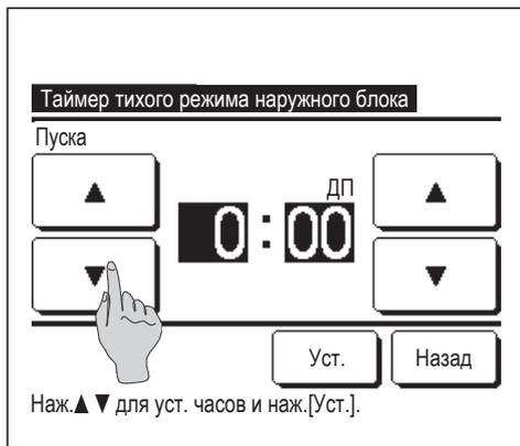
**3** Установите время запуска для таймера тихого режима наружного блока.
