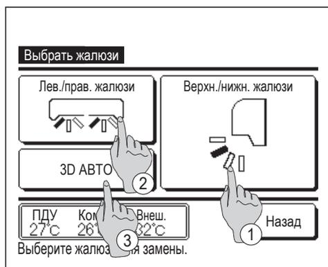
**3** При подключении одного или нескольких FDK с левым/правым жалюзи отображается экран «Выбрать жалюзи». Выберите нужное направление жалюзи.
