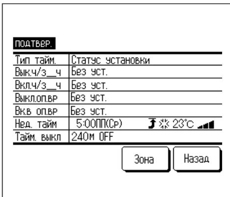
1 При нажатии кнопки **подтвер.** на экране меню «Таймер» отображается содержание текущих настроек таймера.
