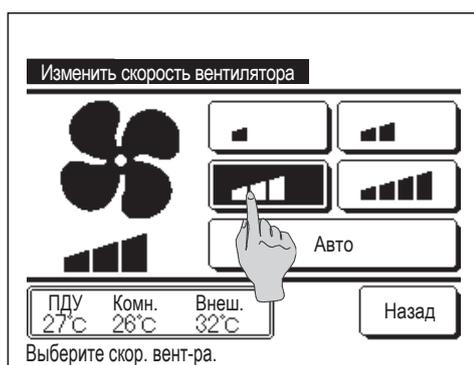
2 После отображения экрана «Изменить скорость вентилятора» нажмите кнопку нужной скорости вентилятора.
