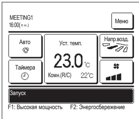
Если датчик ПДУ активирован, отображается температура в помещении (ПДУ) °С (порядок выполнения этих настроек см. в руководстве по установке).
