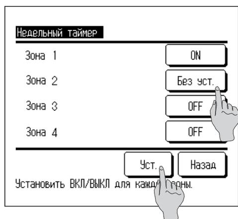
**11** После настройки нужного содержания на экране шага 7 нажмите кнопку **Уст.**
