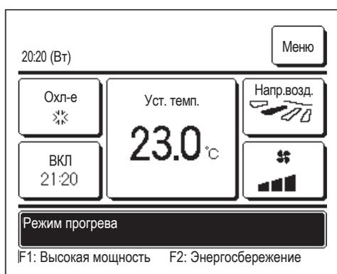
В случае выбора включения прогрева с помощью таймера ВКЛ через промежуток времени (☞ стр. 44) или таймера ВКЛ по часам (☞ стр. 47) работа начнется на 50 - 60 минут раньше, что прогнозируется, исходя из предыдущей операции прогрева, поэтому к моменту достижения времени начала работы температура в помещении будет приближаться к заданной температуре.
