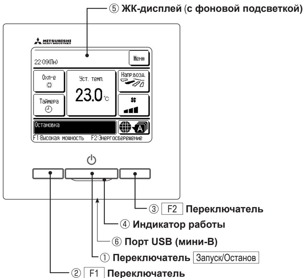
Система с сенсорной панелью, срабатывающая при касании пальцем ЖК-дисплея, применяется для любых действий, кроме ① Run/Stop (пуск/стоп), ② переключателя F1 ③ F2.
