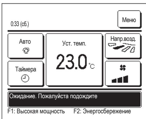
Сообщение «Ожидание. Пожалуйста подождите» может отображаться (максимум 30 минут) на ПДУ во время первого использования после срабатывания прерывателя или отключения электропитания.
