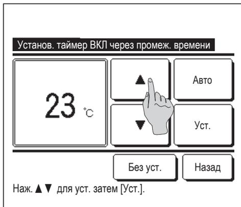
**6** Выберите нужную температуру (с шагом 1°C) с помощью кнопок ▲ ▼. Либо нажмите кнопку Авто и выберите автоматическую настройку температуры.
