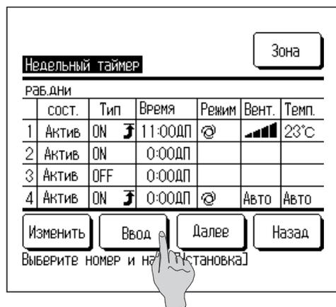
**13** Отображается экран проверки содержания настройки. Для регистрации настройки нажмите кнопку **Ввод**.
