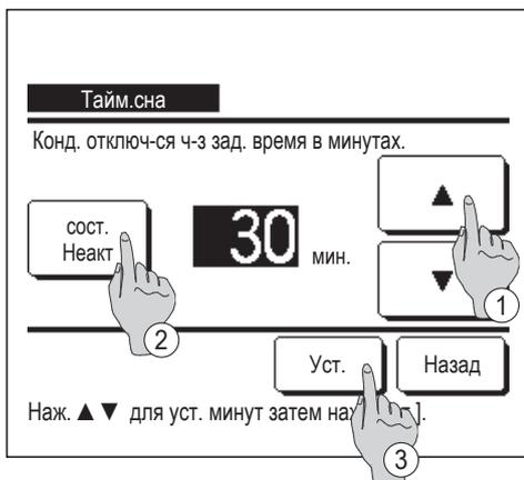
1 Нажмите кнопку **Меню** на ОСНОВНОМ экране и выберите **Настройки энергосбережения** ⇒ **Тайм. сна**. Открывается экран таймера сна.
