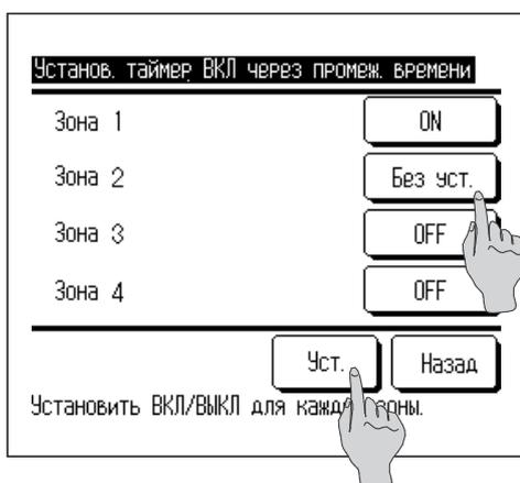
**9** Нажав кнопку Зоны, можно выполнить настройки управления зонами во время работы таймера. Задайте Без уст. / ON / OFF (Без установки/ОТКРЫТЬ/ЗАКРЫТЬ) для каждой зоны в течение работы таймера.
