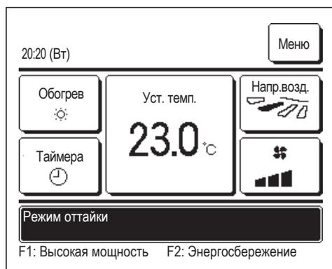
В случае образования инея на наружном агрегате эффективность обогрева снижается. Это приведет к автоматическому переключению устройства на режим оттаивания, и горячий воздух перестанет выдуваться из ИО.
