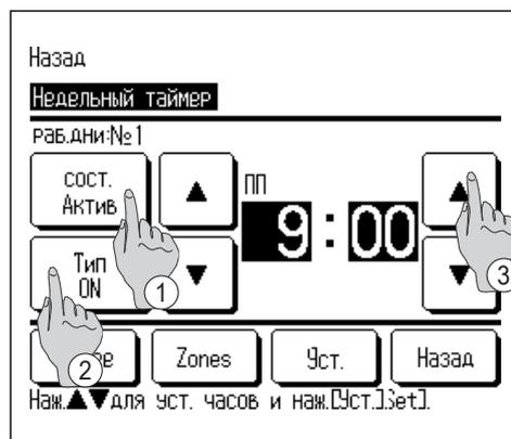
6 Отобразится экран установки таймера.
