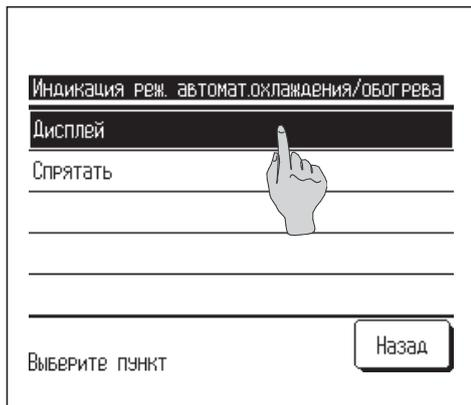
**8** Выберите **Дисплей/Спрятать** для отображения автоматического охлаждения или обогрева.
