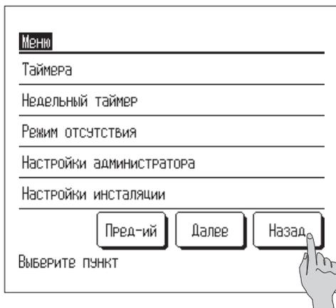
4 При нажатии на кнопку **Назад** (назад) дисплей возвращается на ОСНОВНОЙ экран.
