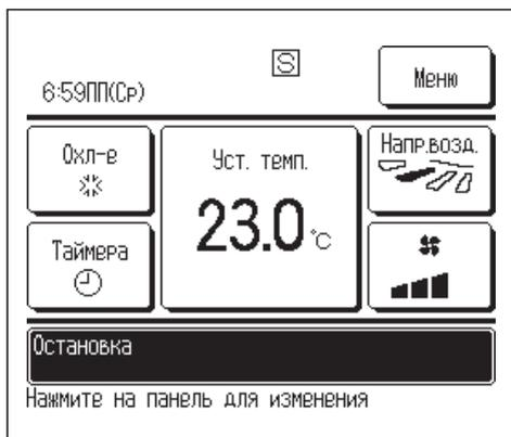
Когда один IU управляется с двух блоков ПДУ, то на вспомогательном блоке ПДУ нельзя выполнить следующие настройки. Необходимо использовать основной блок ПДУ. В случае попытки установить настройки на вспомогательном ПДУ на экране отображается пиктограмма S.
